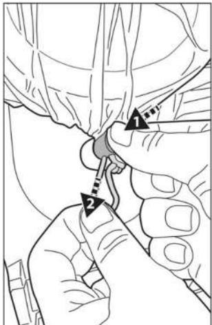
Während Sie die Schnur halten, drücken Sie auf den Schnurbefestigung und schieben Sie ihn unter den Flansch. TIPPS: Um den Filterbeutel zu sichern, ziehen Sie beim Schieben des Schnurbefestigung unter den Flansch eine Schnur anstelle von zwei Schnüre, wie in der Abbildung gezeigt.
