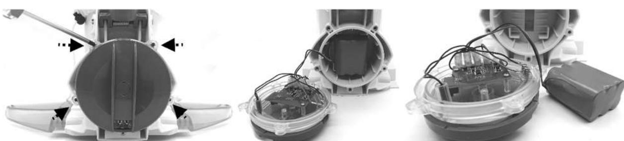
2. Om de batterijverbindingssdraad los te maken, drukt u op de clip van de connector om deze eruit te trekken. **OPMERKING:** Wikkel de connector onmiddellijk met isolatietape in om kortsluiting door het contact van beide draadaansluitingen te voorkomen.
