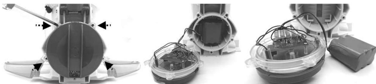
2. Pour détacher le fil de connexion de la batterie, appuyez sur le clip du connecteur pour le retirer. REMARQUE : Enveloppez immédiatement le connecteur avec du ruban isolant afin d'éviter tout court-circuit provoqué par le contact des deux bornes de fil.
