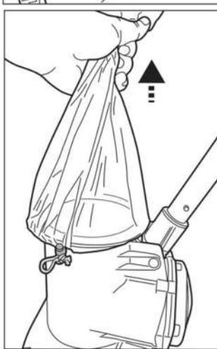
Til de zak op om ervoor te zorgen dat deze volledig is beveiligd voordat u de zwembadstofzuiger in water plaatst.
