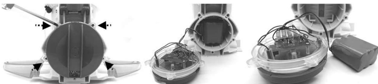
2. Drücken Sie zum Abziehen des Batterieanschlusskabels auf den Clip des Steckers, um ihn herauszuziehen. **HINWEIS:** Wickeln Sie den Stecker sofort mit Isolierband um, um Kurzschlüsse durch den Kontakt beider Kabelklemmen zu vermeiden.
