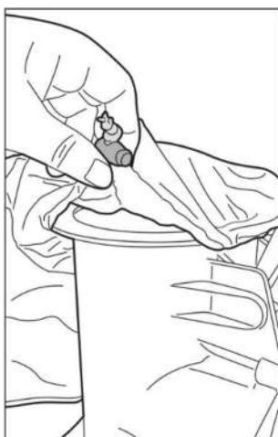
Verteilen Sie den Filterbeutel über der oberen Öffnung des Hauptkörpers des Poolvakuums. Stellen Sie sicher, dass die Schnur des Beutels unter dem Flansch der oberen Öffnung liegt.
